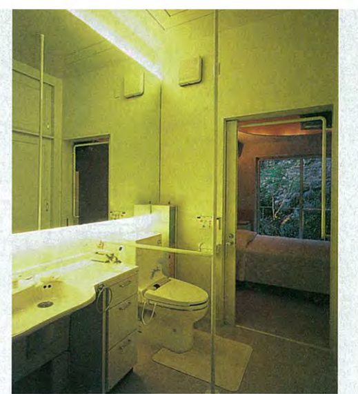
寝室、トイレ、洗面、浴室はフラットに一続きになっていて「夜中にトイレに行くのにとっても便利」(Tさん)
