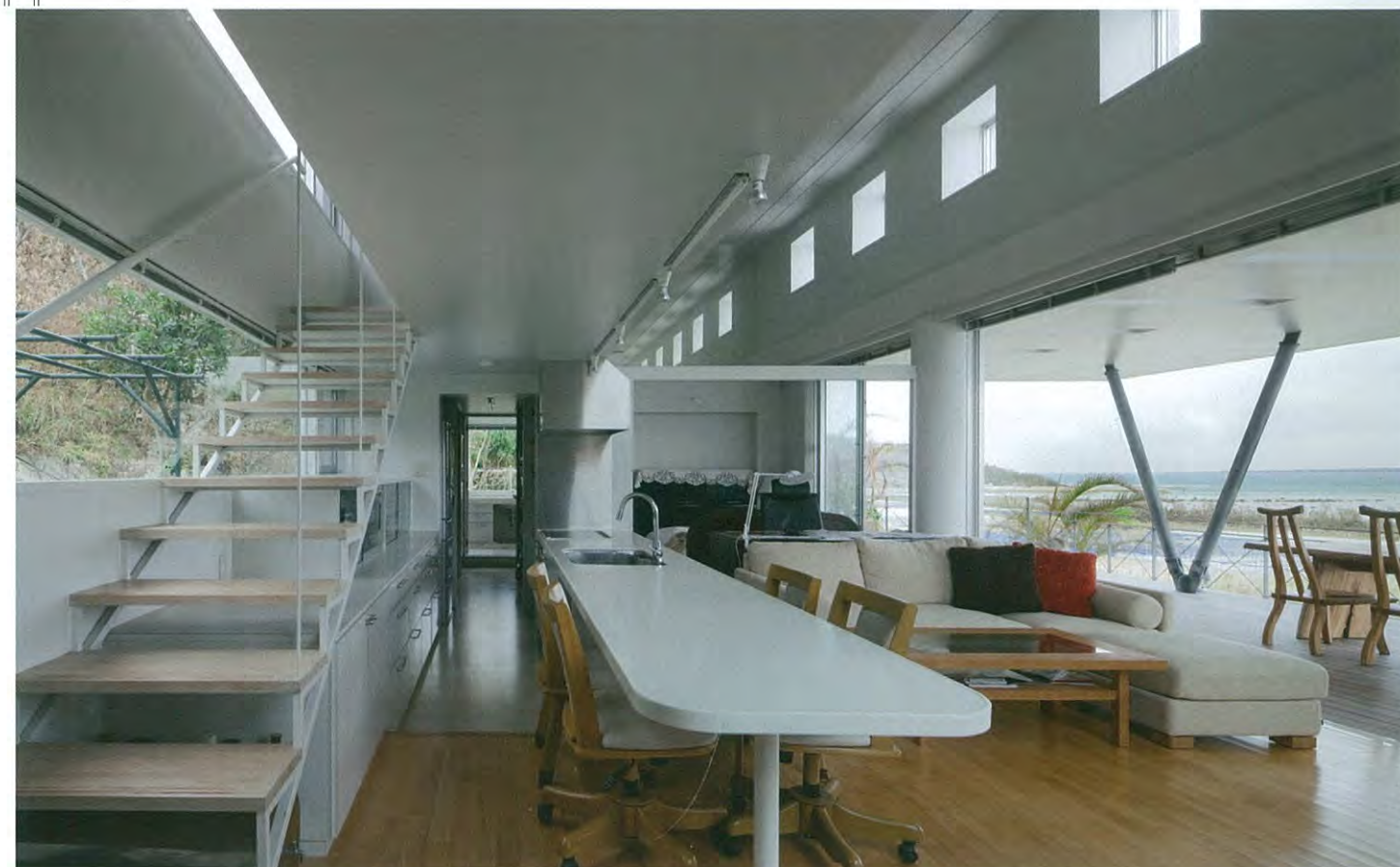
リビングから主屋を見渡す。デッキを覆う庇(10×4.5mm)にはスリット状にトップライトを、また南壁面上部にはハイサイドライトを設けることで十分な明るさを確保している。リビングの天井高さは4,170mm。
